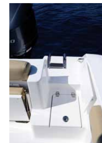
Il portello di accesso dal pozzetto al motore o alle plancette di poppa. E' dotato di chiusura per il suo bloccaggio
