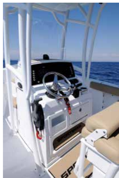
La console di guida è centrale ed il parabrezza in questo caso è un po' più alto di quello fornito di serie, per avere maggior protezione. L'area è chiudibile con tende
