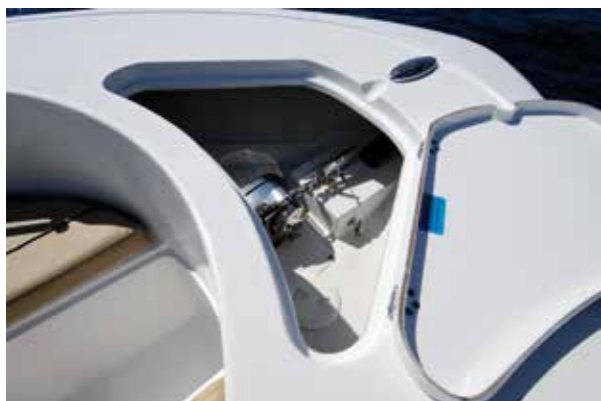
Il gavone per il calumo e l'ancora è rialzato. Internamente si può adottare il verricello elettrico opzionale
