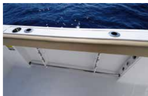
I bordi da 20 centimetri dotati di portacanne e le murate che includono fermapièdi e rastrelliere
