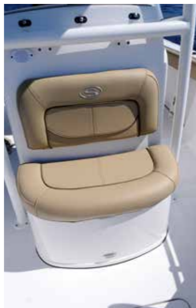
La seduta bi-posto fronte console ospita nella parte inferiore una ghiacciaia da circa 45 litri
