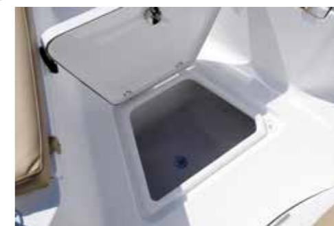
A prua, a pagliolo, un gavone trapezoidale per pescato o per attrezzature. Al centro si noti il drenaggio per l'acqua che viene portata a poppa
