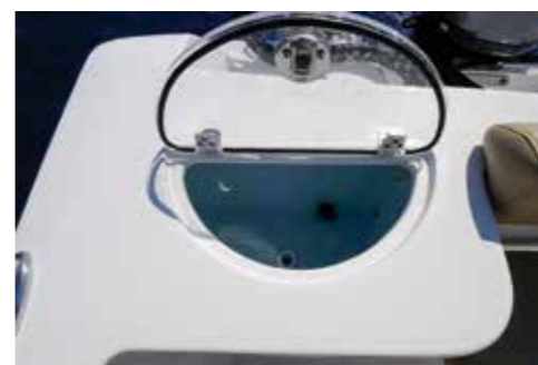
La vasca del vivo con ossigenatore è sistemata sulla murata a baglio. Ha il coperchio trasparente per un miglior controllo del contenuto
